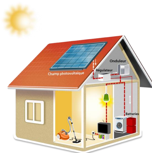
Fig I. 9 : Schéma d'un système PV autonome [24].
