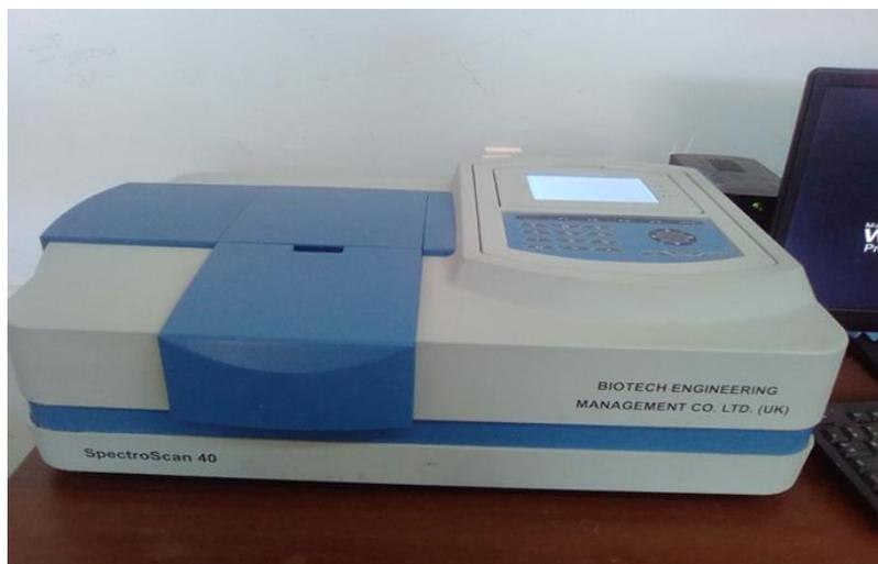
**Figure III.10:**sepectrophotomètre UV-visible A.E (2018)
