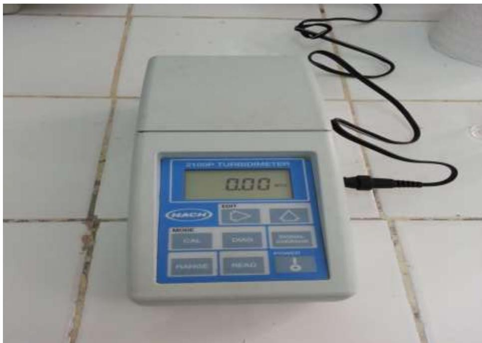
**Figure N°24 - Turbidimètre**
