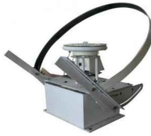
Figure I.5 : Le Pyranomètre (diffus) [10].
