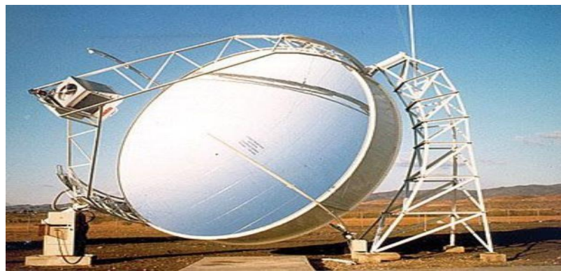
Figure.I.31: Capteur parabolique avec moteur stirling [15].
