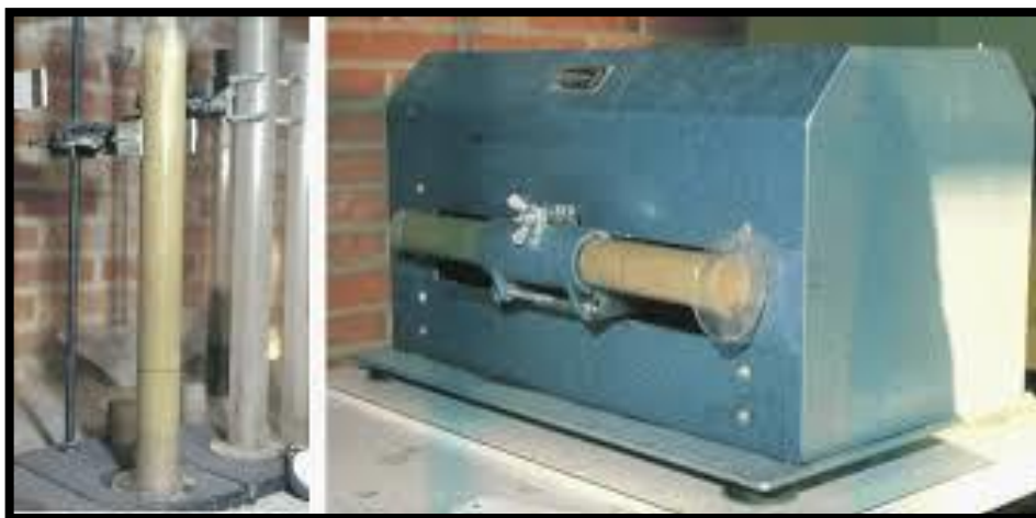
Photo. III. 2: Essai de l'équivalent de sable
