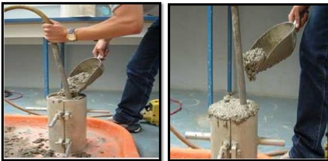
Photo .IV.3: Vibration de béton
