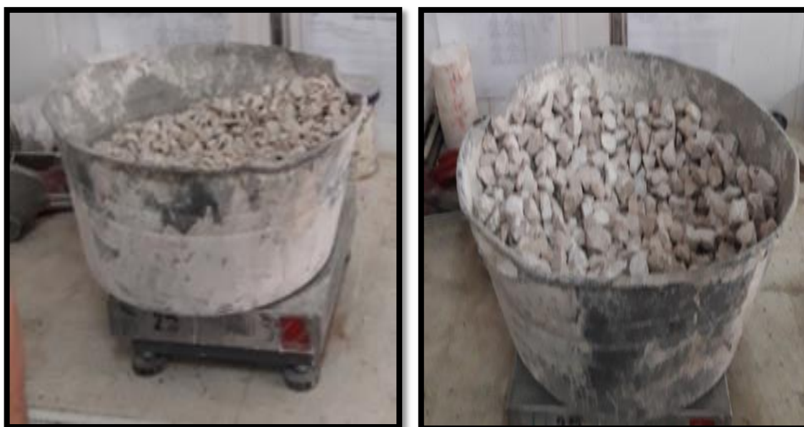
Figure. III.4.: Les graviers concassés utilisés
