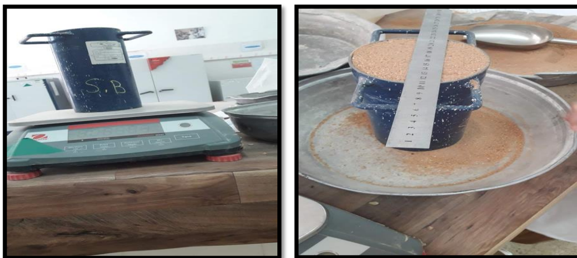
Photo .III. 3: Essai de la masse volumique apparent
