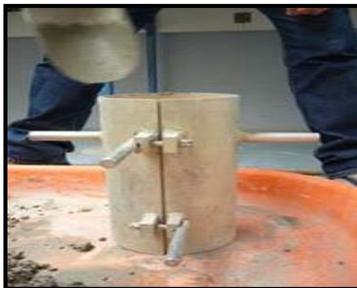
Photo .IV.2. : Remplissage de l'éprouvette
