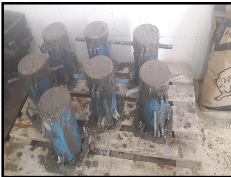
Photo .IV.5. : Les éprouvettes remplies au béton.
