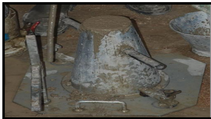
Photo .IV.1 : Cône d'Abrams rempli, piqué et arasé
