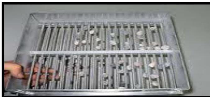
Figure .III.5. Essai d'aplatissement
