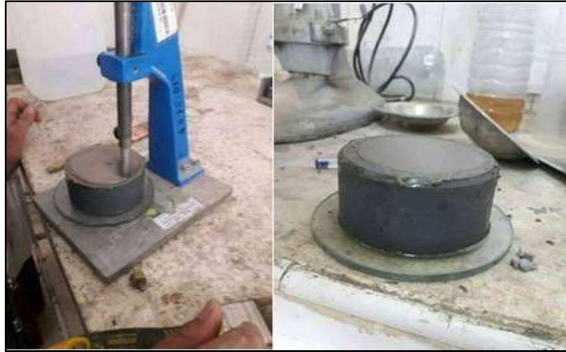
PhotoIII.12 : Essai de consistance de ciment
