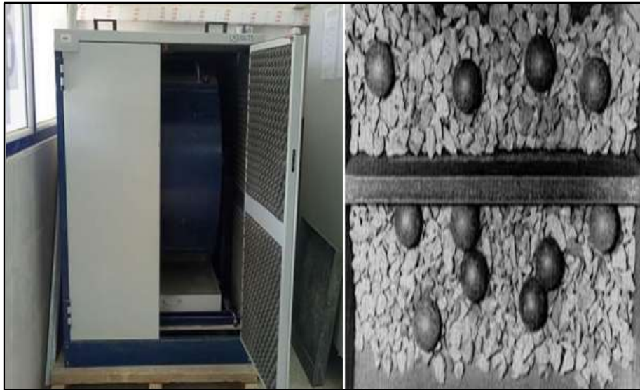
Photo III.10: Essai de LOS ANGLES
