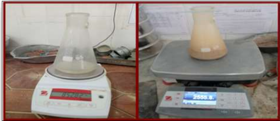
PhotoIII.3: Essai de la masse volumique absolue
