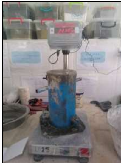
Photo I.2: Essai masse volumique
