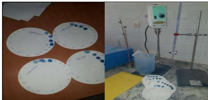
PhotoIII.6 : Essai de bleu méthylène
