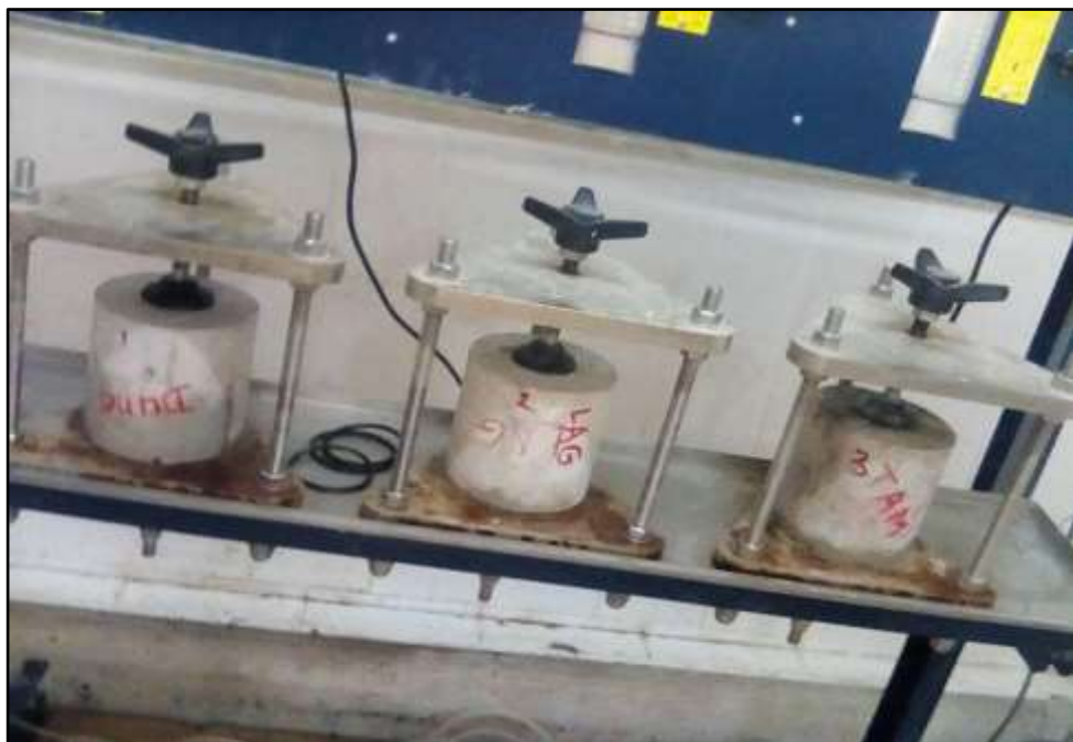
Photo V.4 : Essai de pénétration d'eau sous pression pour les 3 éprouvettes
