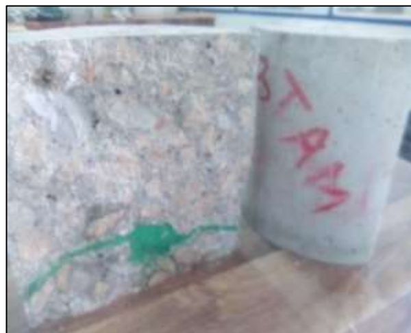
Photo V.7 : Résultat d'essai pénétration d'eau sous pression pour l'éprouvette de B1-MF3.06
