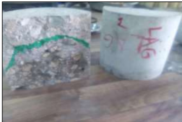
Photo V.6 : Résultat d'essai pénétration d'eau sous pression pour l'éprouvette de B3-MF2.02
