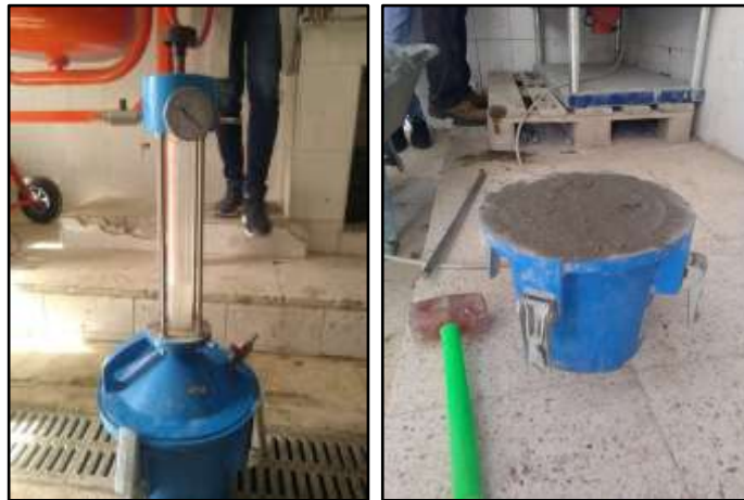
Photo I.1: Essai teneur en air occlus.
