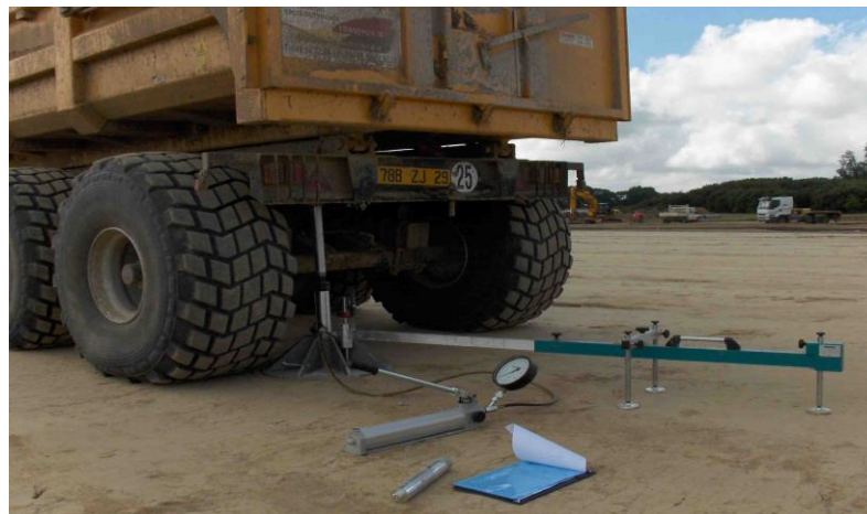
Photo N° 2-07 : Dispositif de l'essai de chargement à la plaque
