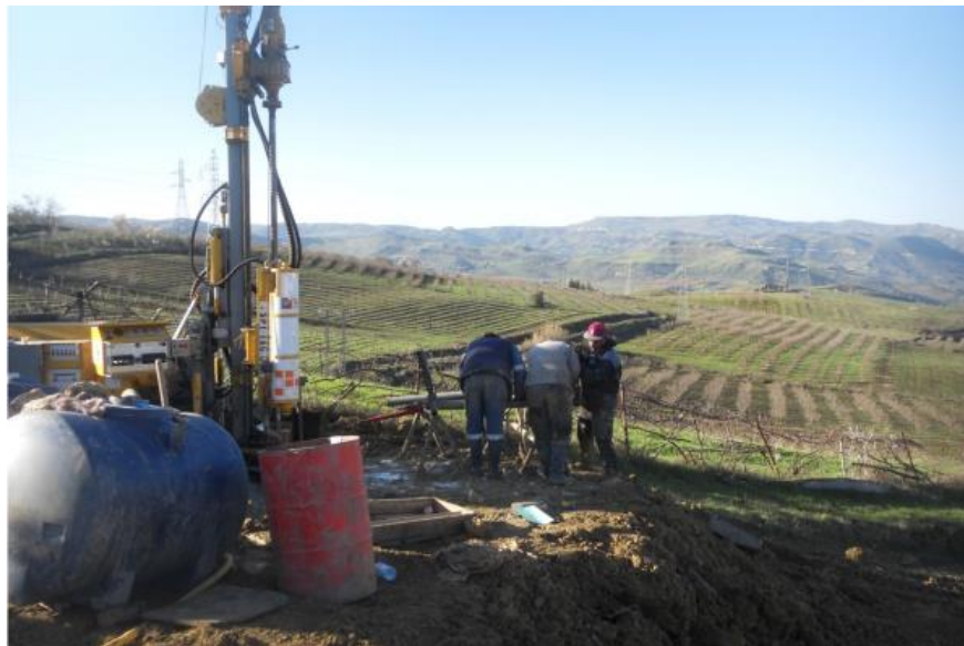
Photo N°4-01 : Sondage carottier sur site
