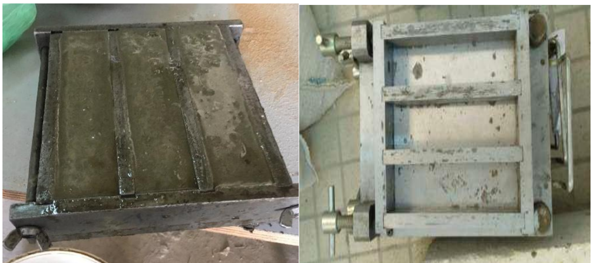
Photo.III. 2.Moule normalisé de 4x4x16 cm 2
