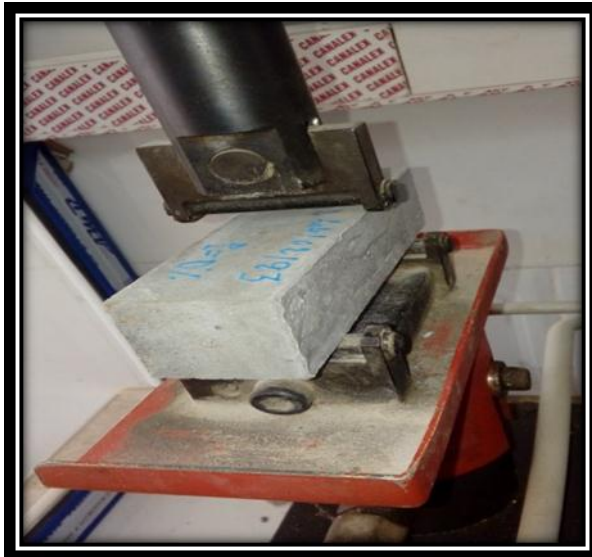
Photo.III. 4.Essai de résistance à la flexion (3 points).
