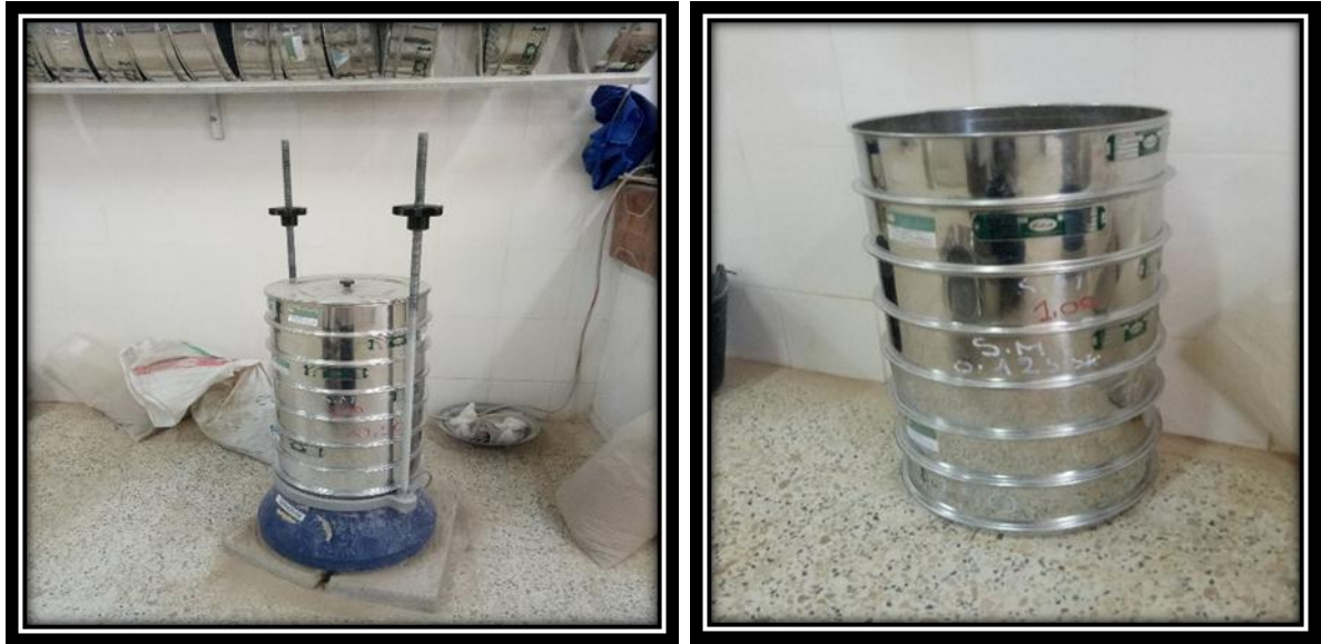
Photo.II. 4. Les tamis utilisés de l'analyse granulométrique du PET
