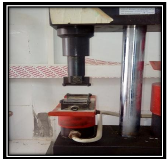
Photo.III. 4.Essai de résistance à la flexion (3 points).
