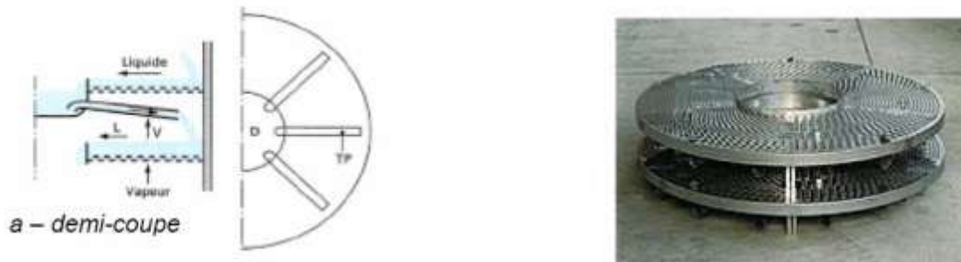
Figure IV.12 : Colonne à plateaux Kühni de type A. [22]
