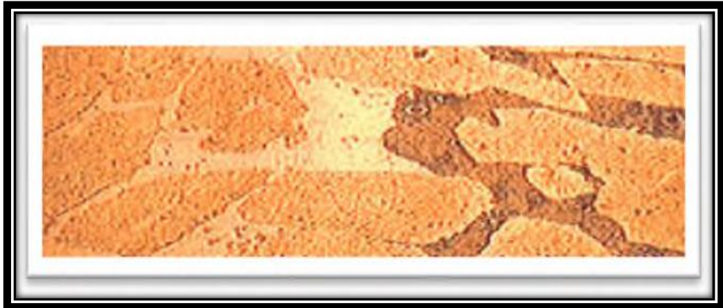
Figure I-15 : Coupe métallographique Montrant une corrosion sélective d'un laiton
