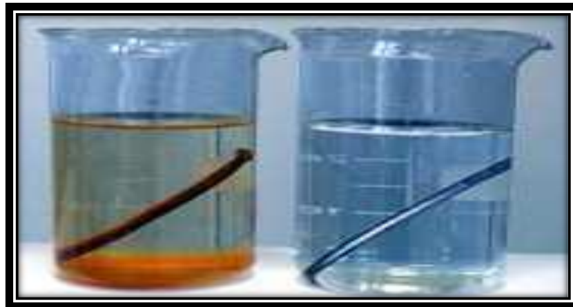
Figure II.1 : Métal au contact d'un milieu agressif : (a) sans inhibiteur de corrosion, (b) avec inhibiteur de corrosion.
