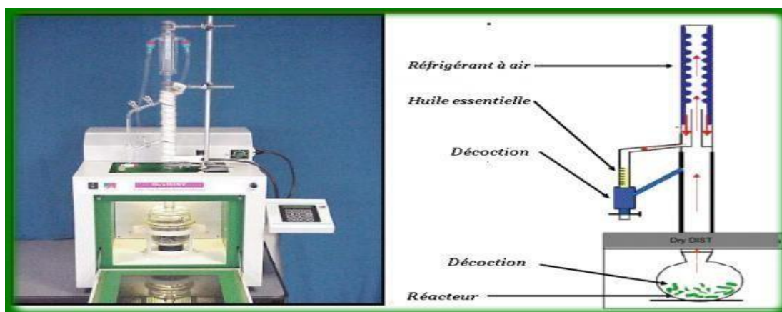
Figure 9: Principe schématisé de l'appareillage d'hydrodistillation sous micro-ondes[61]
