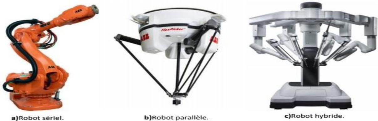
**Figure 1.2** Robots manipulateurs
