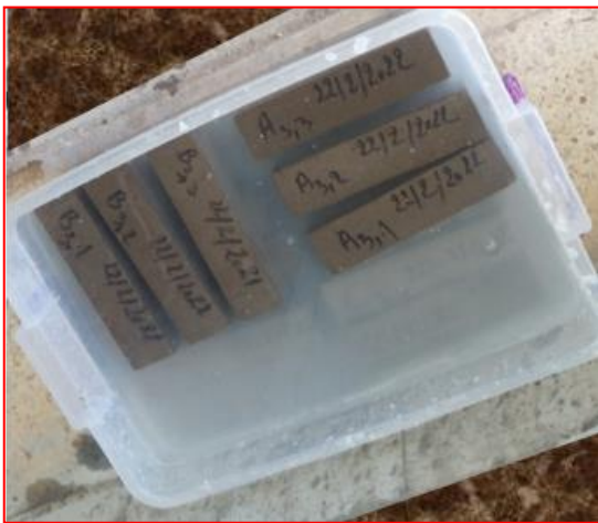
Figure II. 21 : Échantillons du mortier l'immerge dans solution de la chaux.
