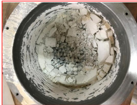
Figure II. 15 : Filler calcaires et de boules sphériques à l'intérieur du cylindre.
