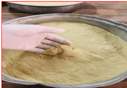
Figure II. 12 : la bentonite après un broyage mécanique.
