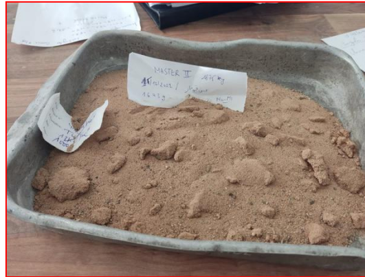
Figure II. 4 : sable d'essai Teneur d'eaux.
