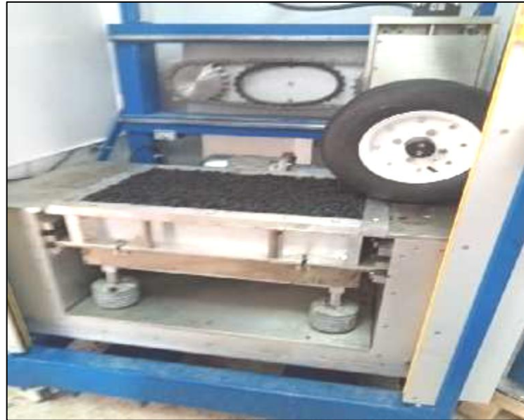
Photo II.14. Compactage des plaques.
