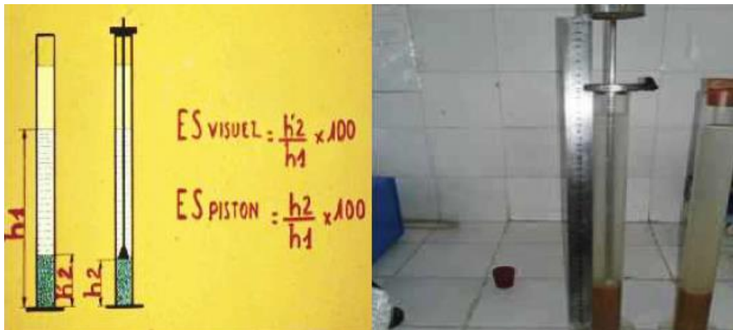
Figure. III.3 : Principe d'essai d'équivalent de sable.
