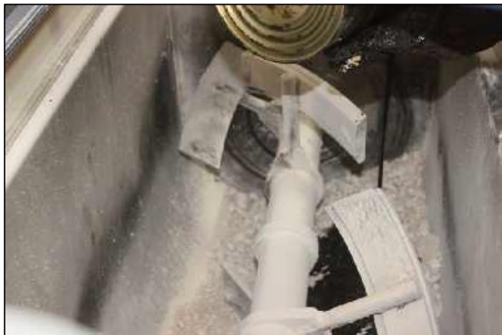
Photo II.2. Malaxage des granulats avec un bitume pur.
