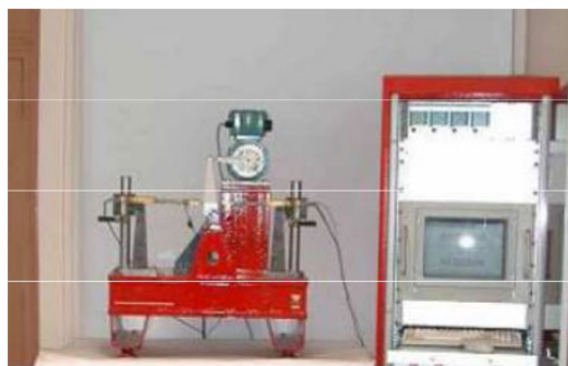
Photo I.2. Essai de fatigue en flexion 2 points sur éprouvettes trapézoïdales [9]
