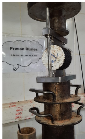
Photo III.7 : Traction indirect par la presse Duriez
