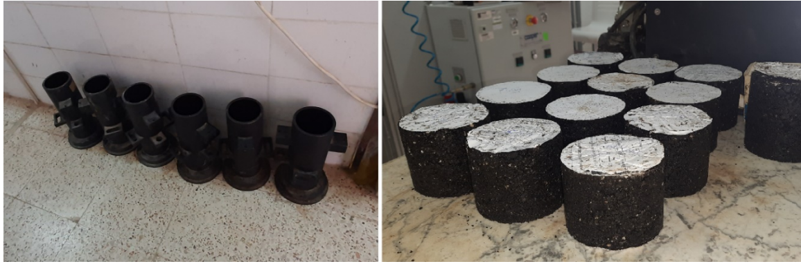
a) Les Moules compaction giratoire
