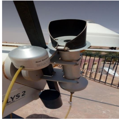
Figure (2.4) : Photo d'un pyrhéliomètre monté sur un tracker solaire (photo du labo gisement solaire de l'URAER)
