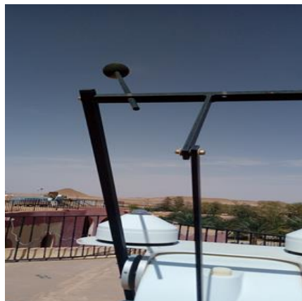
Figure (2.6) : Photo du pyranomètre mené d'une boule pare-soleil pour mesurer le diffus (photo du labo gisement solaire de l'URAER)
