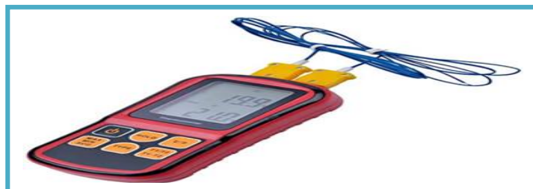
Figure III.3: Appareil de mesure de la température (thermocouples de type (K))
