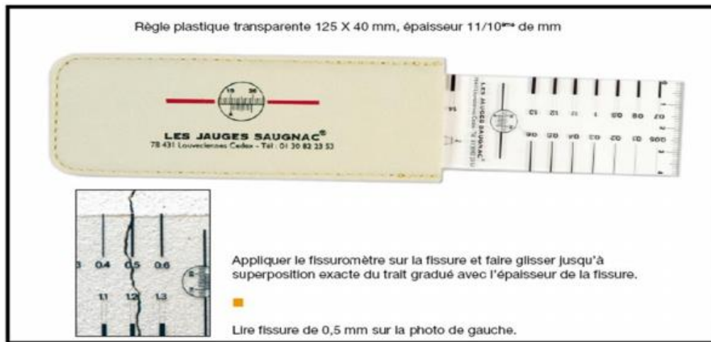
Figure 7: Les jauges Saignac. [4]
