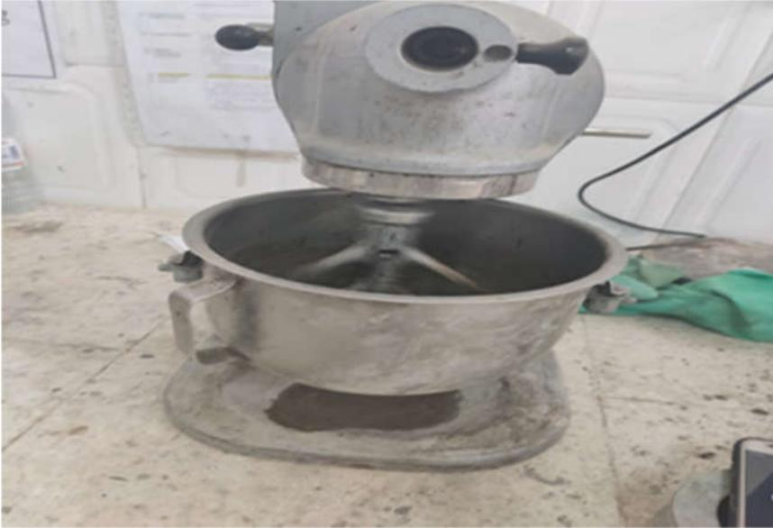
**Photo .II.18. Malaxeur électrique utilisée dans la fabrication du mortier [Labo Béton –LTPS]**
