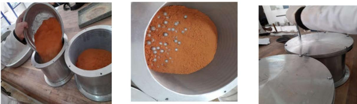
**Photo .II.14.Granulés de brique dans le Moule de la machine de Micro Duval avec granulés de fer**
