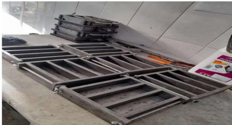
**photo .I.1.Moule pour moulage des éprouvettes de mortier.**
