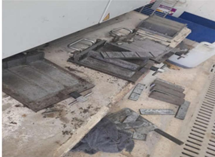
**Photo .II.22. Démoulage des éprouvettes**
