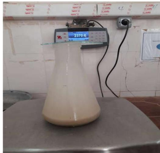
photo.II.2.Essai de détermination de la masse volumique absolue
