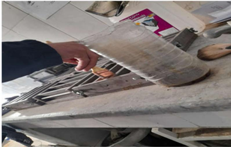
**Photo .II.20. Lubrification des moules**
