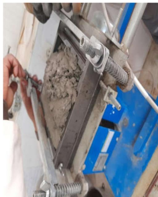
**Photo .II.21. Remplir le moule et le mettre dans l'appareil à chocs**
