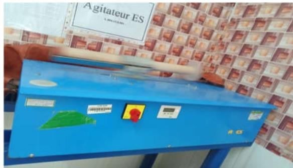
Photo .II.4. Agitateur mécanique à LTPS
