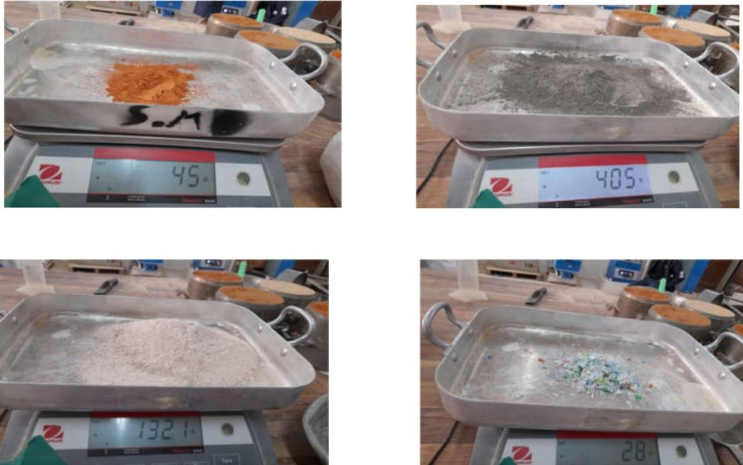
Photo .II.17. Pesage des composants du mortier
