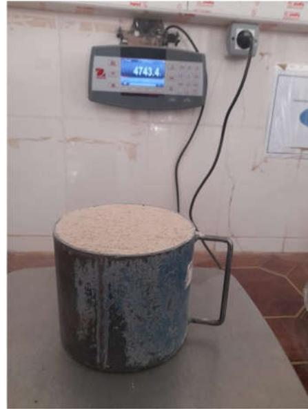
**Photo .II.3.Essai de détermination de la masse volumique apparente a LTPS**
