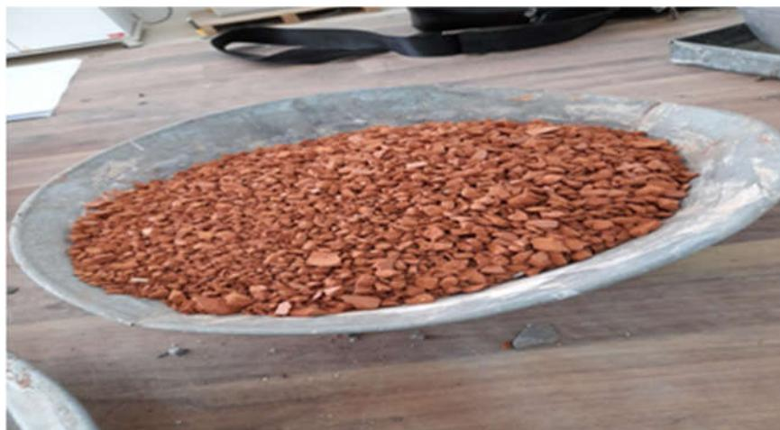
**Photo .II.12. Les granules des briques que nous obtenus De la machine concasseur**
