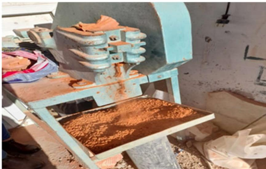
**photo.II.11. La machine de concasseur des briques**
