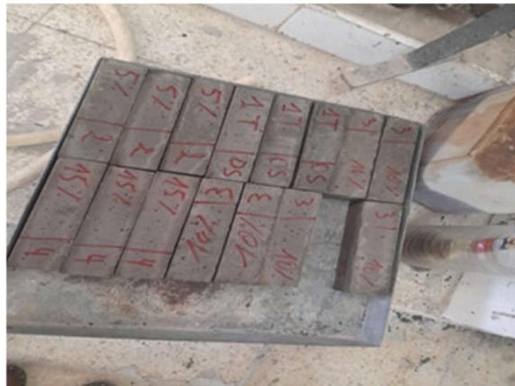
**Photo .II.23. Nommer les éprouvettes pour conserver dans la chambre humide**
