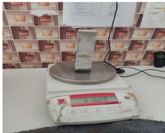
Photo .II.25. Essai d'absorption d'eau par capillarité
