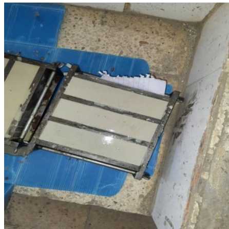
شكل رقم (16.III) يوضح القالب بعد الصب
