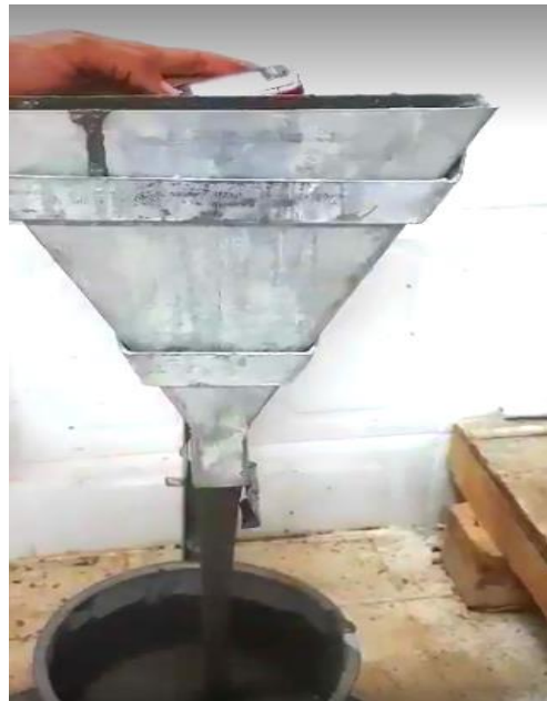
شكل رقم (13.III) يوضح طريقة تجربة انسياب الملاط في القمع
