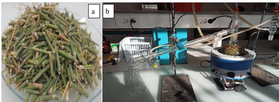
Figure II.3 : Extraction d'huile essentielle de a) Pituranthos chloranthus avec b) processus d'hydro distillation.
