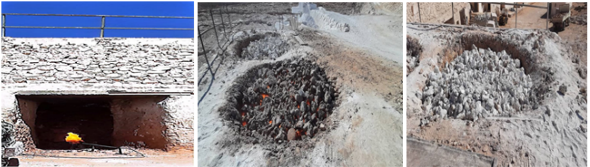
FIGURE 3.1 – Roche calcaire avant et après calcination ( Photo originale )
