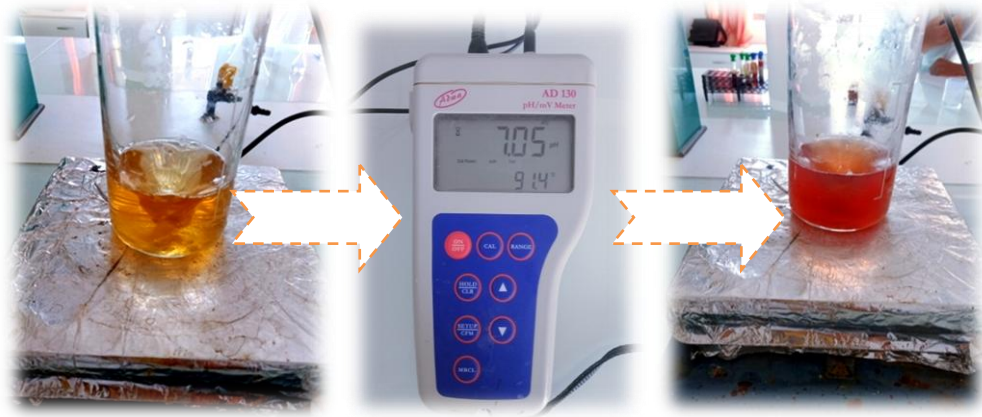
Figure II.6 : Ajoute de NH_4OH dans la solution pour le PH=7.
