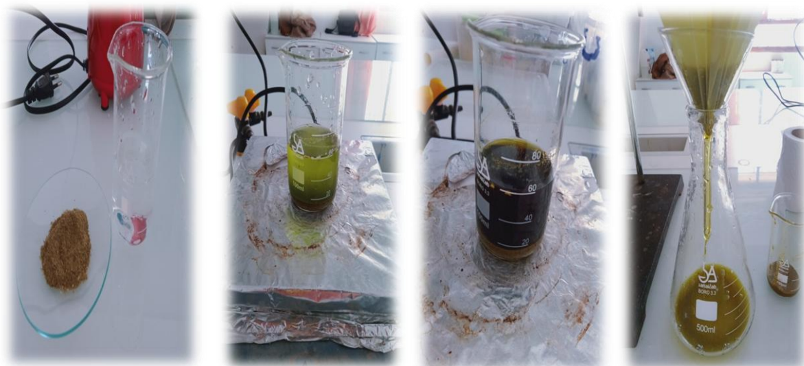
Figure II. 15: Schéma d'extraction solide-liquide dans méthanol.
