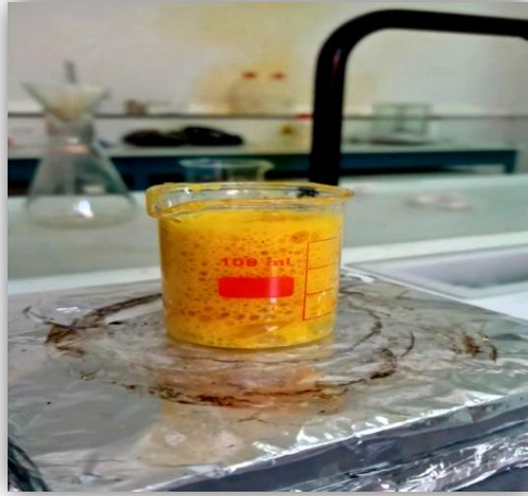
Figure II. 7 : le procédé d'auto-combustion grâce à l'existence de plant d'O. pes- caprae .
