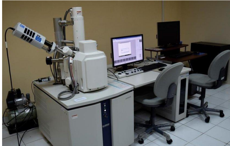
Figure II.22: Appareil de MEB couplé à l'EDX «SU3500».
