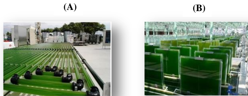
Figure I.4 : Photographie des Photo bioréacteurs tubulaires-
