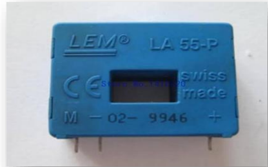
Figure 46: Capteur de courant.
