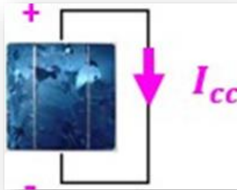
Figure 9: Courant de court-circuit d'une cellule solaire.
