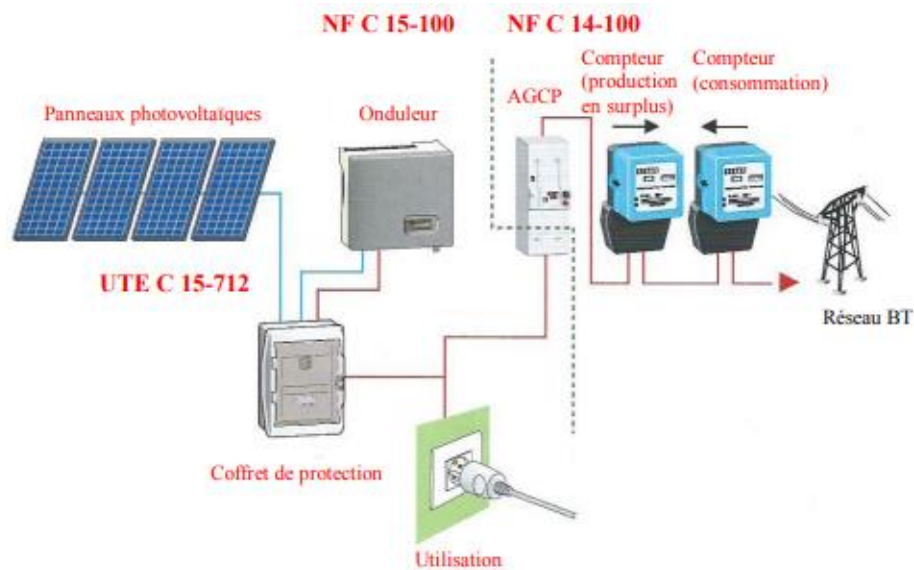
Figure I.6 : Injection énergie supplément dans le réseau.
