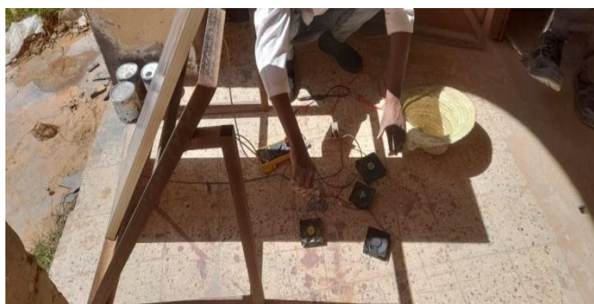
Fig.III.14 : Ventilateurs Alimentées Panneau Solaire.
