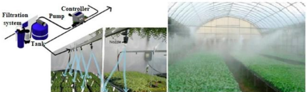
Fig. II.8 :Schéma de refroidissement par un système de brumisation [14].
