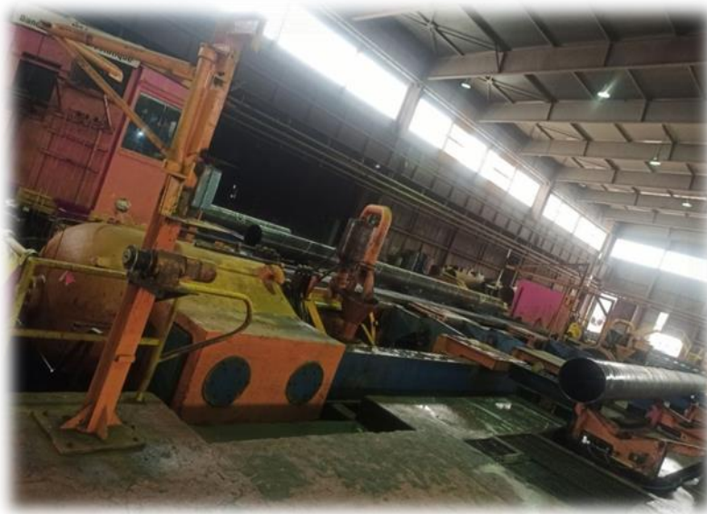
FIG I. 6. Banc d'essai hydrostatique
