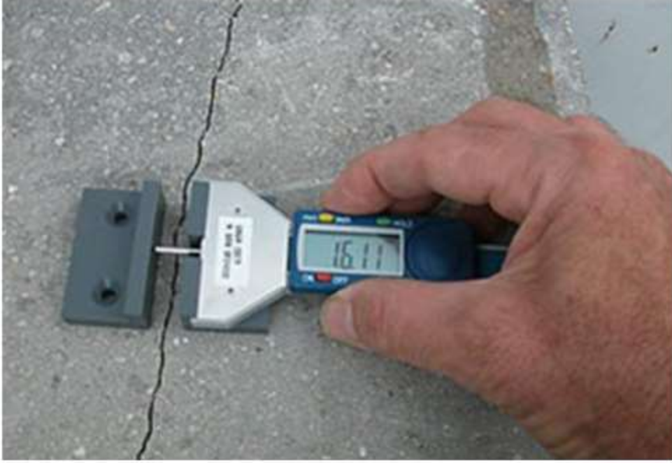
ملحق (1.3): جهاز قياس الشقوق المكبر.
