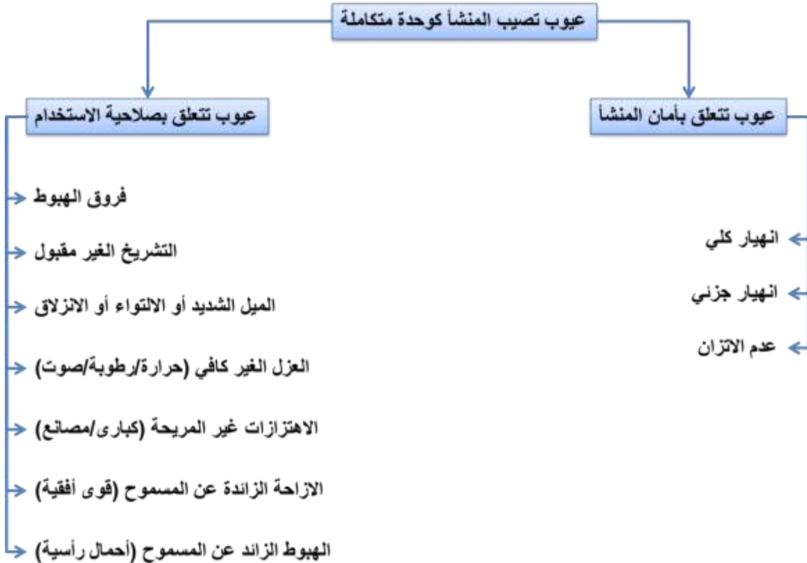
شكل (1.2): ملخص لأهم العيوب التي تصيب المبنى كوحدة متكاملة.
