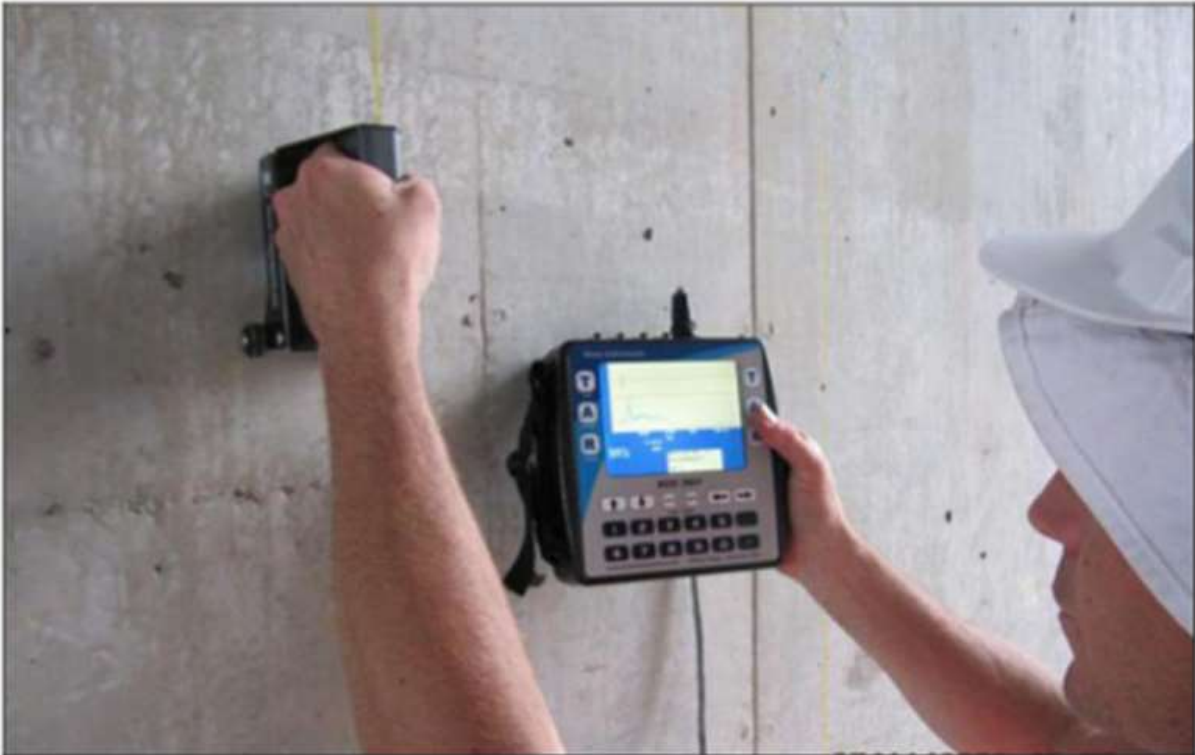
ملحق (2.3): جهاز قياس تآكل حديد التسليح.
