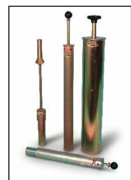
**Figure II.6: Masse de compactage (Pilon)**
