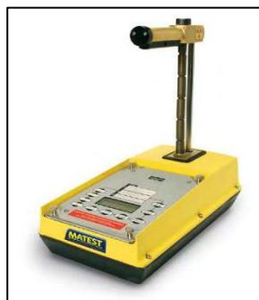
**Figure I.3 : Appareil de Gamma-densitomètre**
