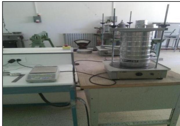
**Figure III.6: Appareillage d'analyse granulométrique (Ghazal a 2023)**
