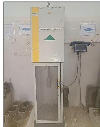
**Figure III.29: l'appareil Proctor au laboratoire**
