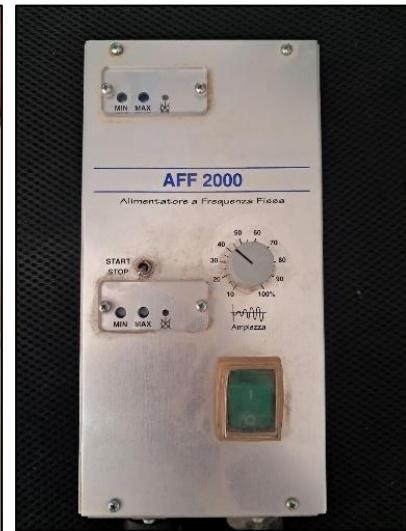
**Figure IV.6 : Alimentatore II a fréquence fixe**
