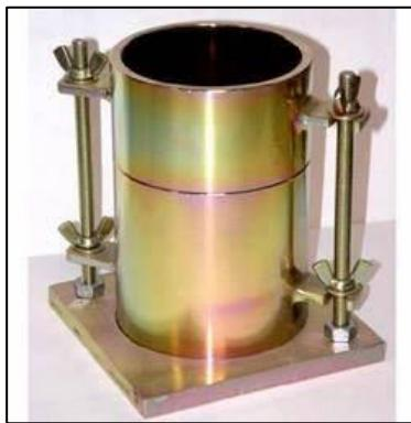
**Figure III.28: Le moule Proctor**
