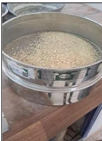
**Figure III.23 : Tamis de 2 mm pour éliminer les gros grains**
