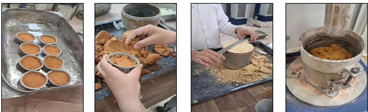
**Figure III.30: Étapes d'Exécution de l'Essai Proctor au Laboratoire**
