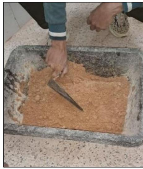
**Figure III.27:** Mélange manuel des constituants (Sable de dune + Argile)
