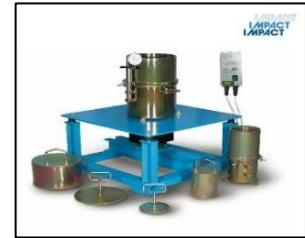
**Figure II.2:** Table vibrante de laboratoire
