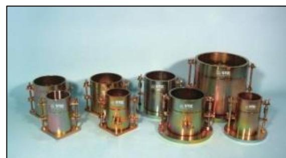
**Figure II.5 : Moule cylindrique de proctor**
