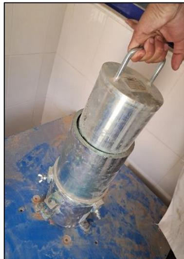
**Figure IV.5 : places des moules et l'échantillon pour vibrer**
