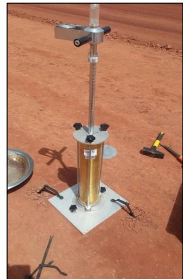
**Figure I.2: Appareil de Densitomètre à membrane**
