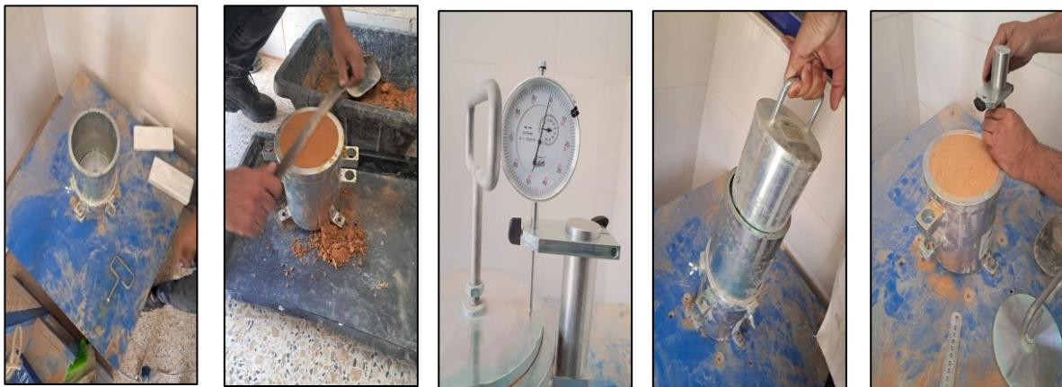
**Figure III.32: Étapes d’Exécution de l’Essai table vibratoire au Laboratoire**
