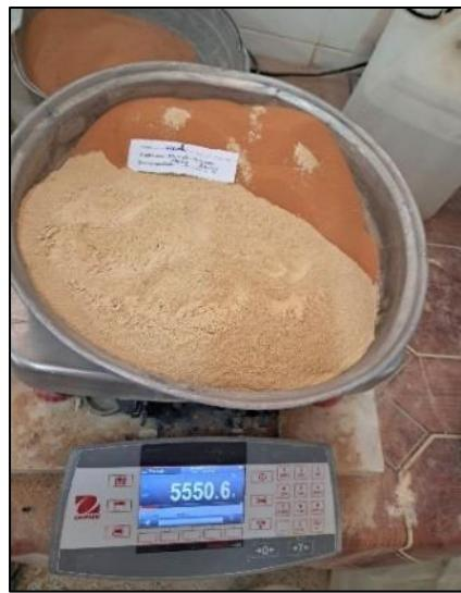
**Figure III.26:**Pesée précise du sable de dune et de
