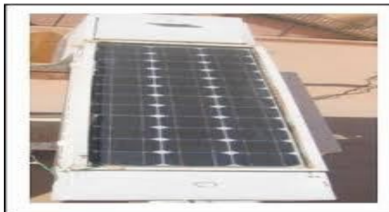
Figure 2.3 : Prototype de modèle PVT à air réalisée à l'URAER [2]
