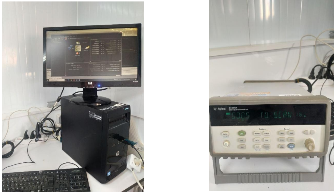
Figure 3.14 : Ordinateur de bureau et appareil de mesure Agilent 34970A.
