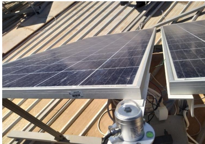
Figure 3.10 : Pyranomètre utilisé pour la mesure du rayonnement solaire global.
