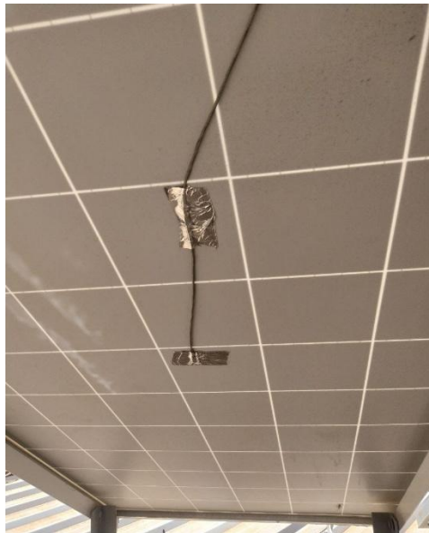
Figure 3.11 : Thermocouple installé pour la mesure de la température des modules photovoltaïques.
