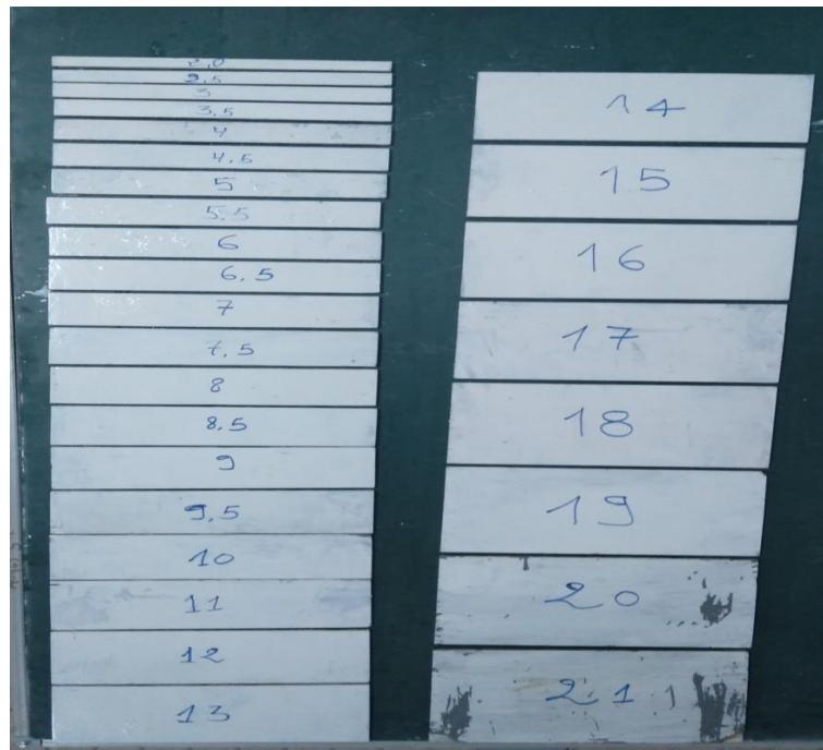
**Photo 6:** Les parois minces pour contrôler un écoulement de passage des régimes.
