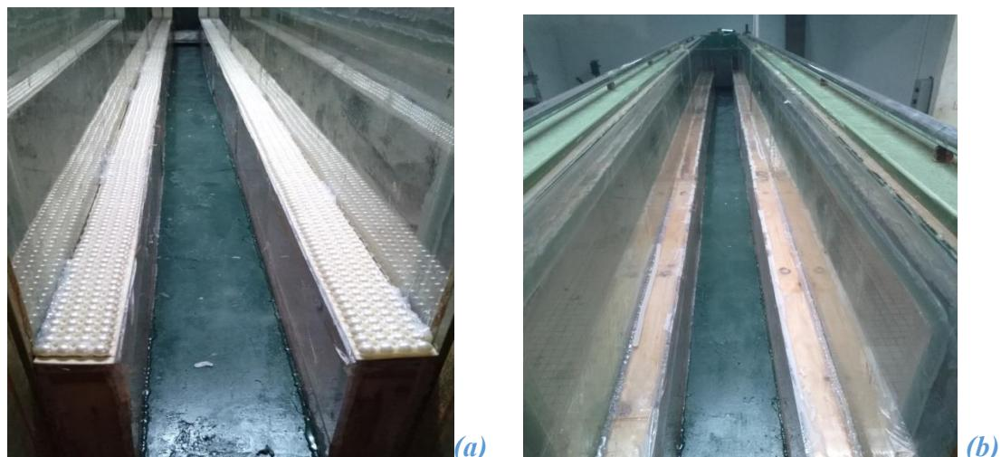
Photo 7: a) section composée rugueuse b) section composée lisse.
