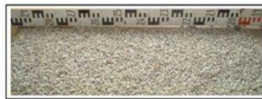
Figure 1: Tapis rugueux de rugosité équivalente  $\bar{z} = 8,73\text{mm}$
