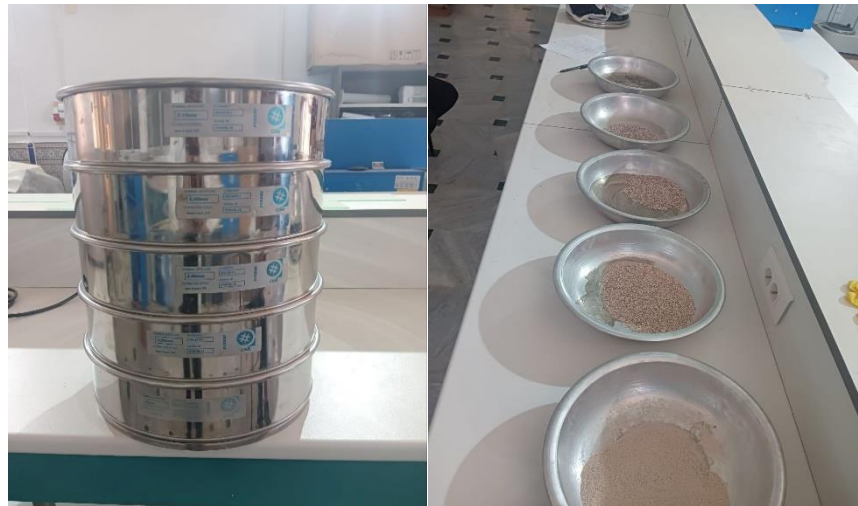
Figure (III.3) : Analyse granulométrique par tamisage
