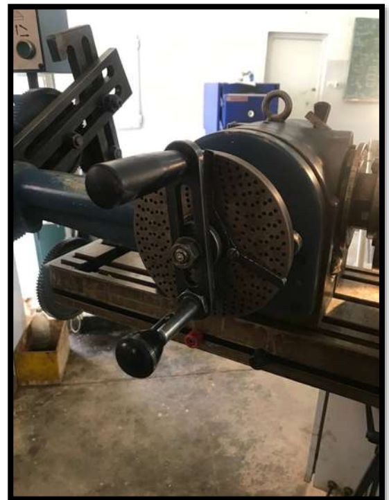
Figure IV.4: Diviseur 1/40 pour le déplacement entre dents d'engrangement
