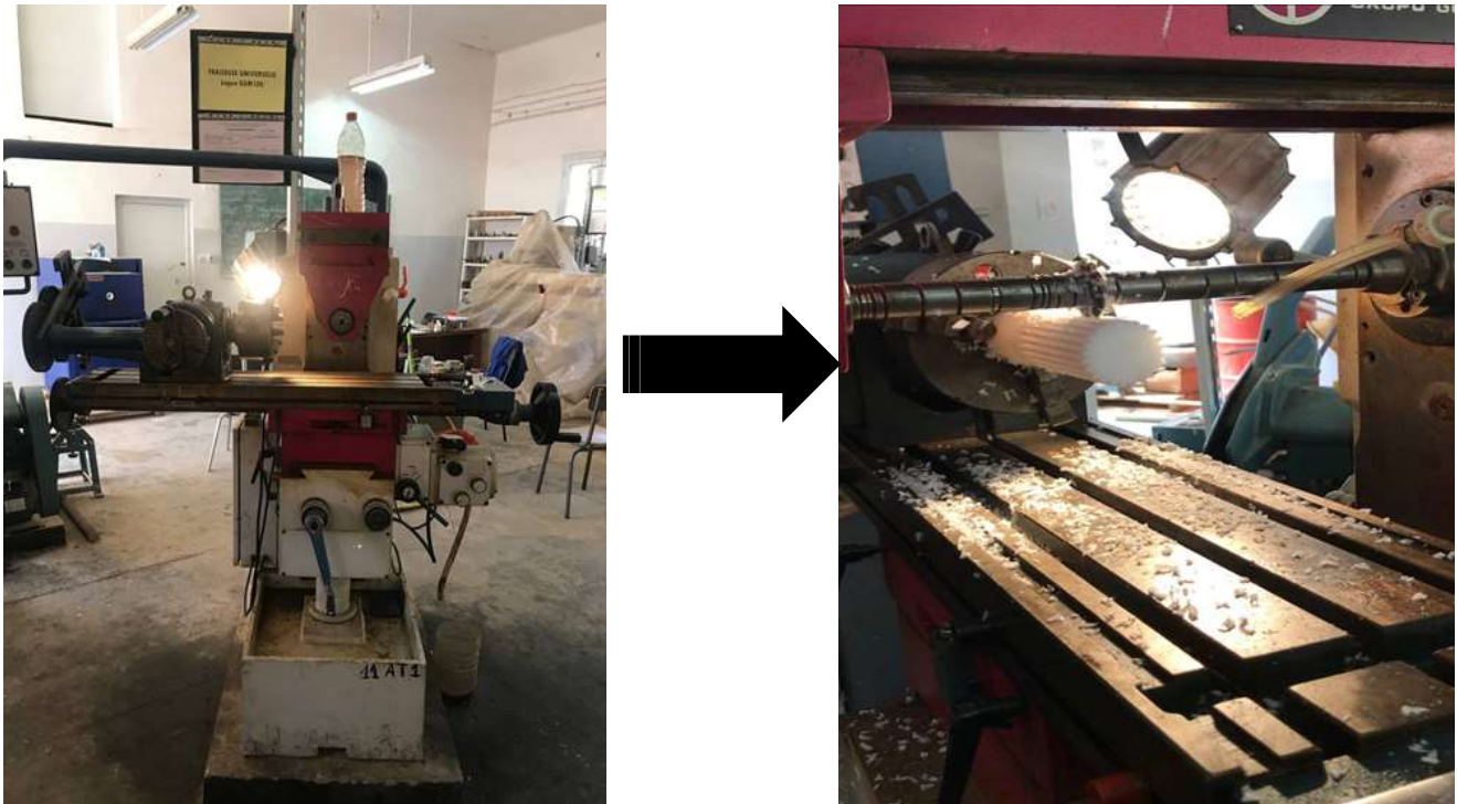
Figure IV.3: Taillage des dents d'engrangement sur fraiseuse avec diviseur
