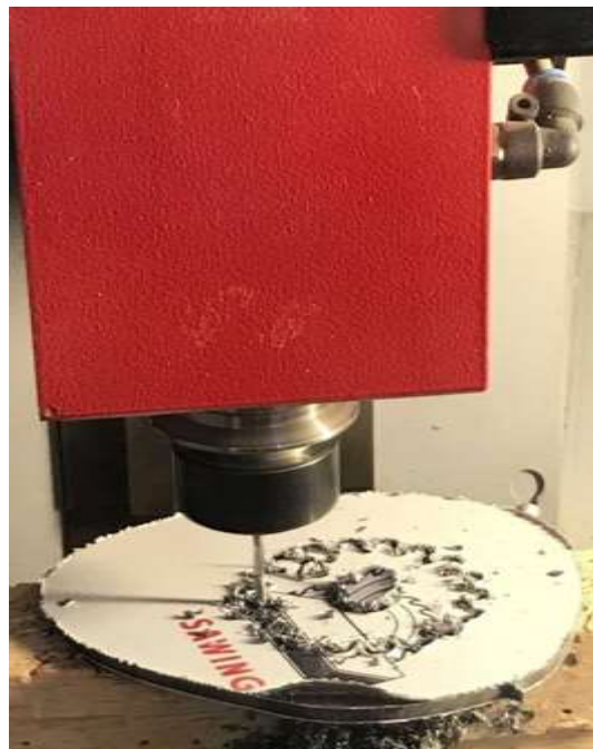
Figure IV.18: Fraisage de l'engrenage en cours sur machine CNC
