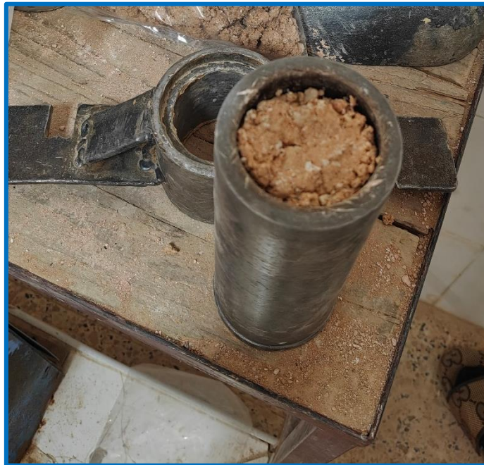
Figure. III.12: Moulages des éprouvettes en sable de dune et de tuf compactés dans le moule de Proctor Modifié.
