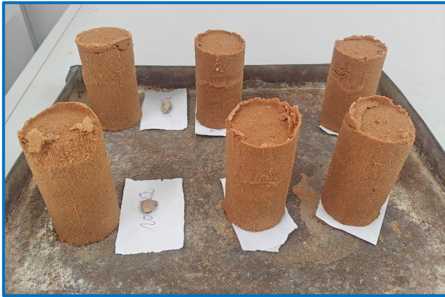
Figure. III.13: Démoulages des éprouvettes de sable de dune compactés dans le moule de Proctor Modifié.
