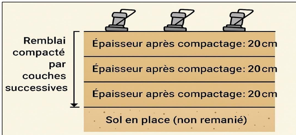
Figure I.3 : Illustration montrant des couches de sol compactées [6].
