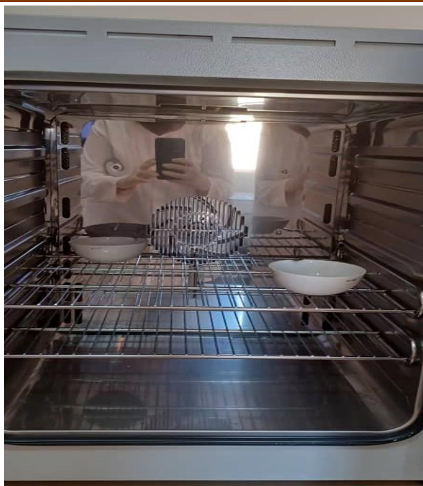
Séchage des filtres dans l'étuve
