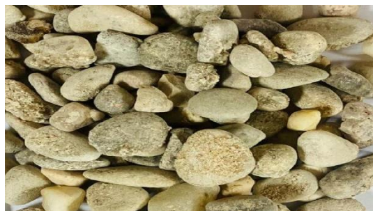
Figure III.1 : Pierre de la vallée utilisée comme matériau de stockage thermique
