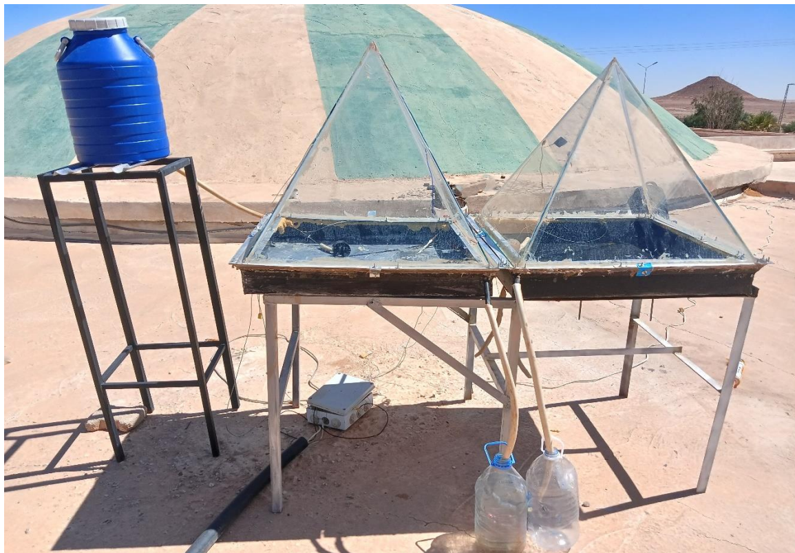
Figure.III.9 : Les distillateurs solaires pendant l'expérience
