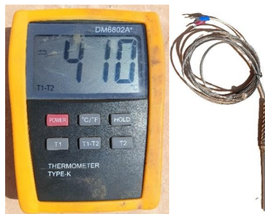
Figure.III.6: Thermometer (TYPE-K) avec cable thermocouple
