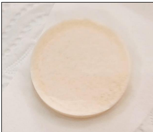
Figure III.4 : Suspension de CNC obtenue après filtration.
