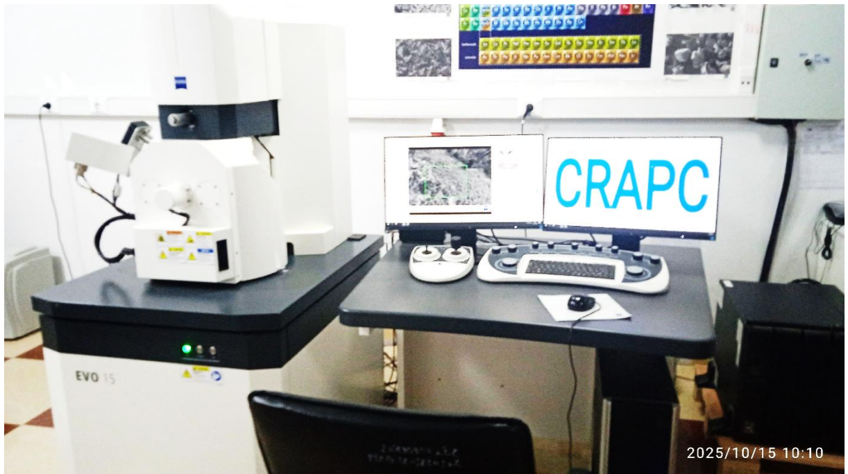
Figure II.19 : Microscope Electronique à Balayage
