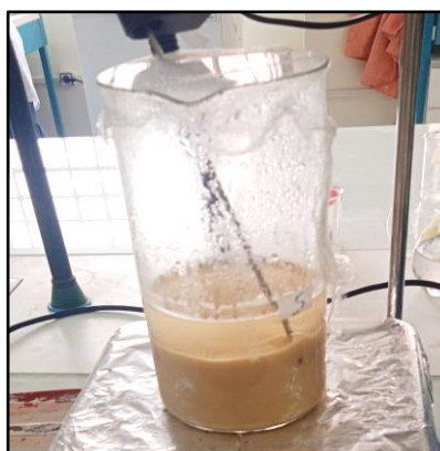
Figure II.4 : Trempage du bois dans l'eau chaude
