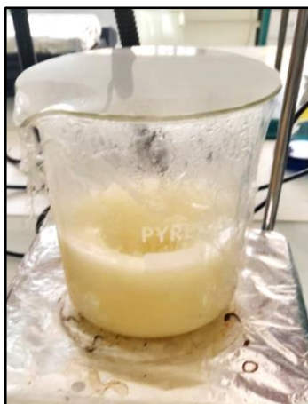
Figure II.7 : Blanchiment avec l'hypochlorite de sodium ( \text{NaClO} ).
