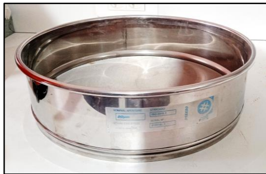
Figure II.2 : Tamis utilisé pour la granulométrie ( 80 \mu\text{m} < d < 63 \mu\text{m} ).
