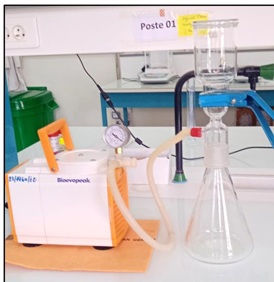
Figure VI.1: Filtration sous vide du CNC.
