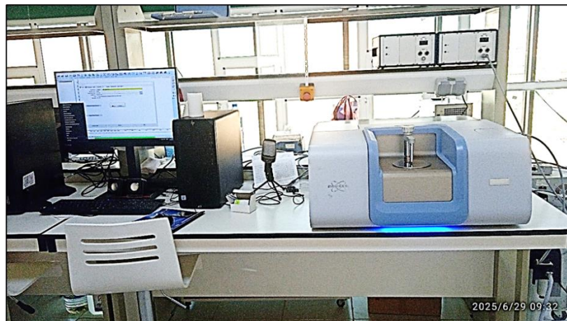
Figure II.17 : Spectrophotomètre FTIR (Bruker) CRPCI Laghouat
