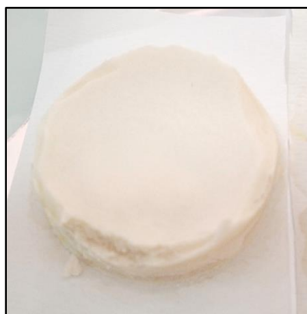
Figure II.8 : Cellulose extraite et séchée.
