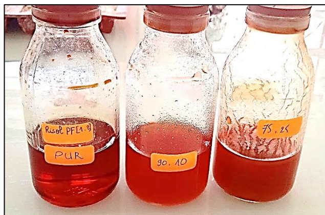
Figure II.12 : Synthèse de PF / CNC composite
