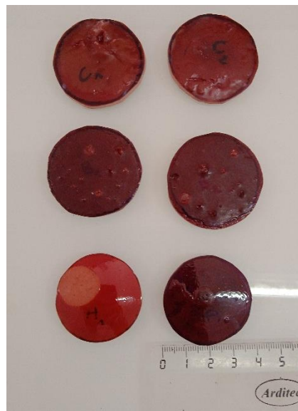
Figure II.22: Image des échantillons utilisés dans la mesure de constant diélectrique \mu_r
