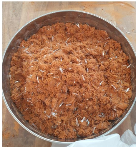
Figure 2:10 Préparation du mélange sable-fibres (PP).
