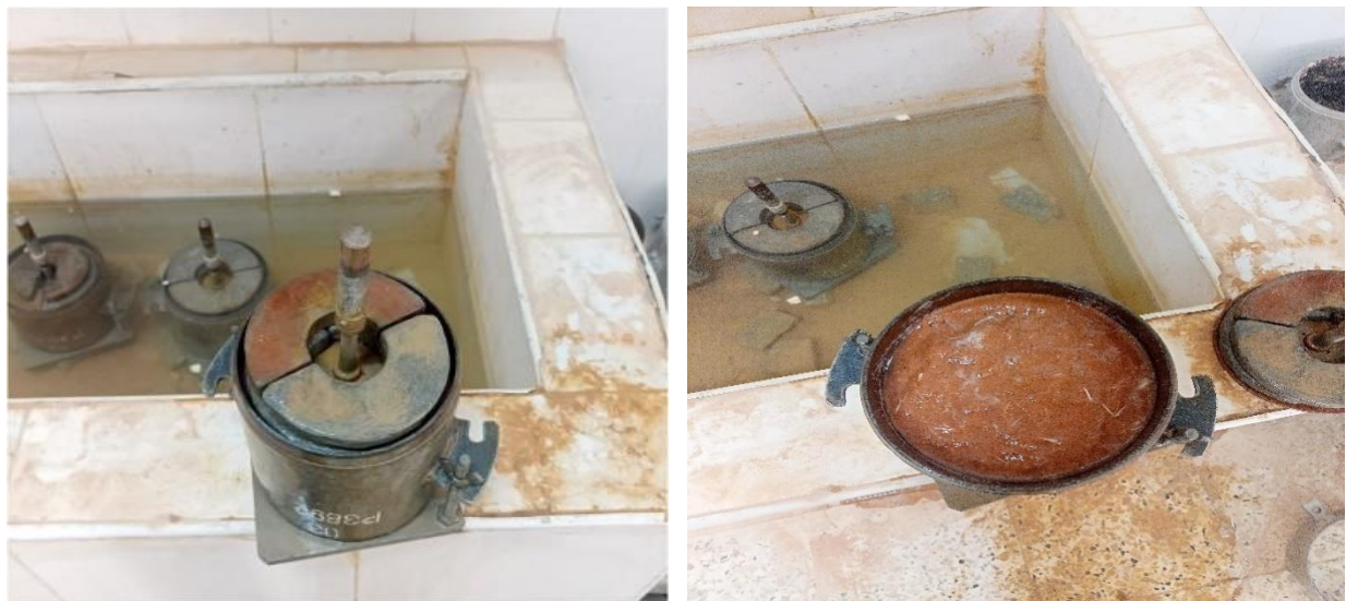
Figure 4:18 L'échantillon de sable traité et/ou renforcé compacté est immergé pendant 4 heures dans un bain d'eau.
