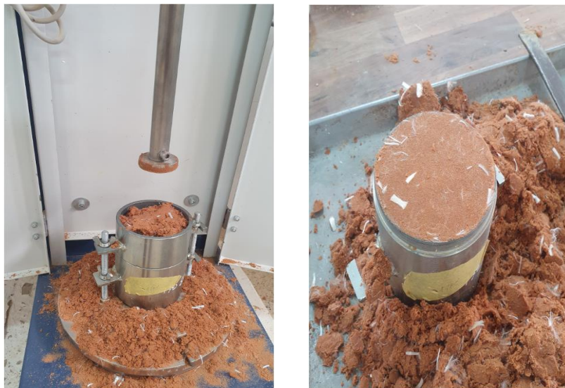
Figure 2:11 Moule de compactage avec échantillon Sable-PP compacté
