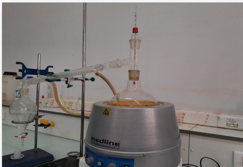
Figure III.4 : Montage d'hydrodistillation (distillation simple).
