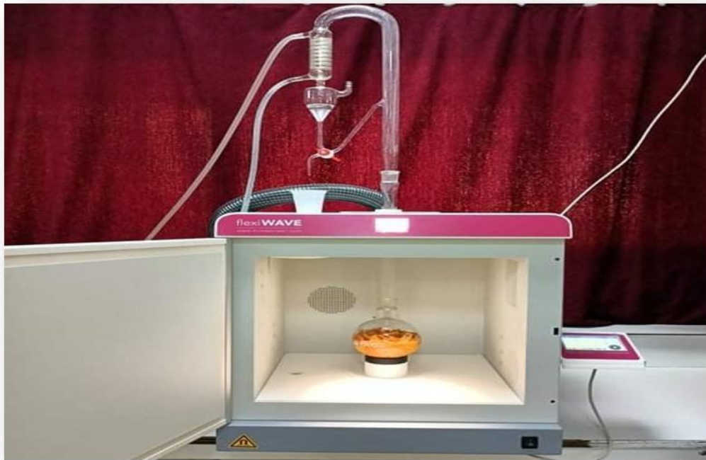
Figure III.6 : Montage d'extraction par micro-ondes.
