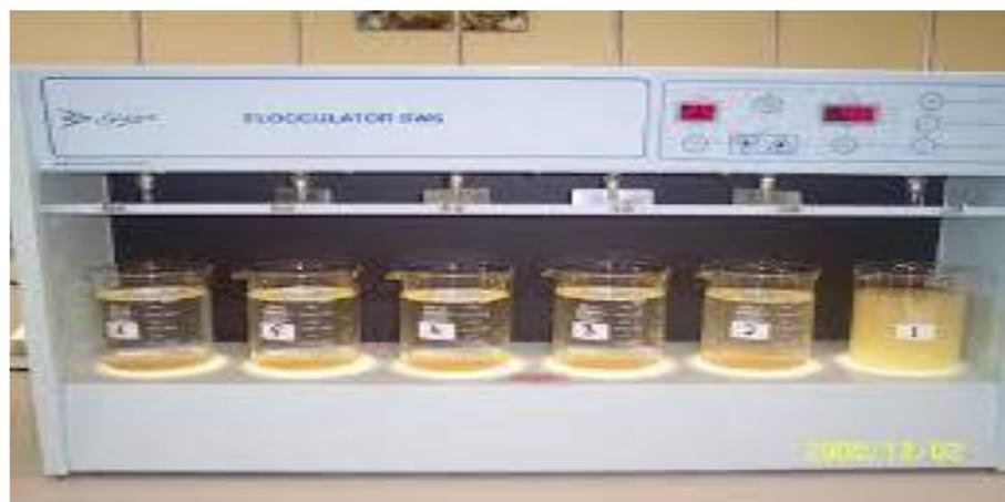
**Figure 16** Les échantillonneuses sous l'appareille JAR-TEST
