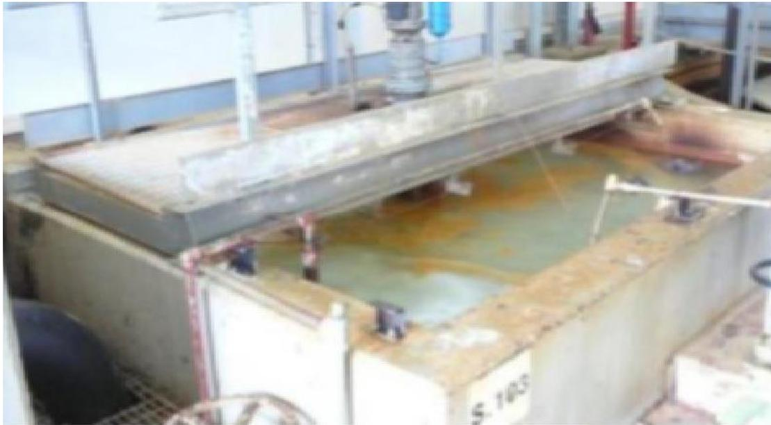
**Figure 12 Cuve flocculation « S-103**
