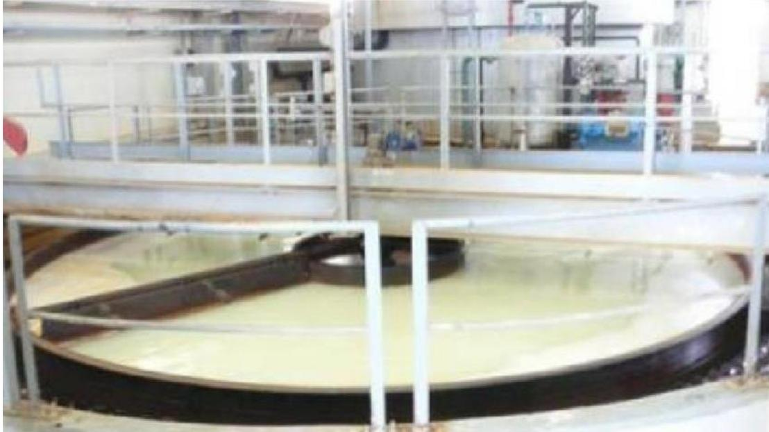
**Figure 13 la cuve de flottation « S-104**
