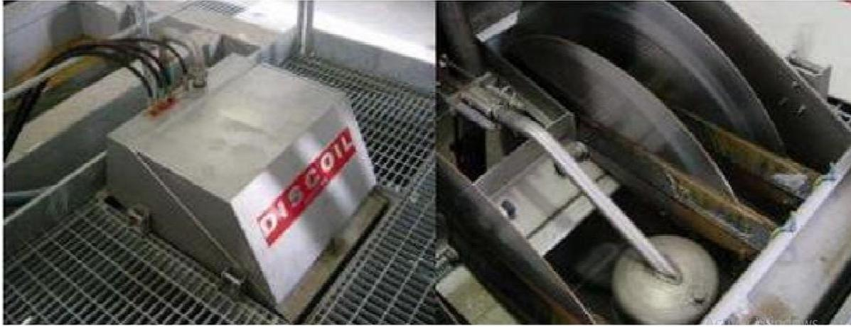
**Figure 10 déshuileur flottant à disque rotatifs(Discoil) MS-107.**
