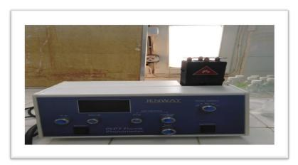
Photo N° (III. 05):Spectromètre à flamme(JENWAY).
