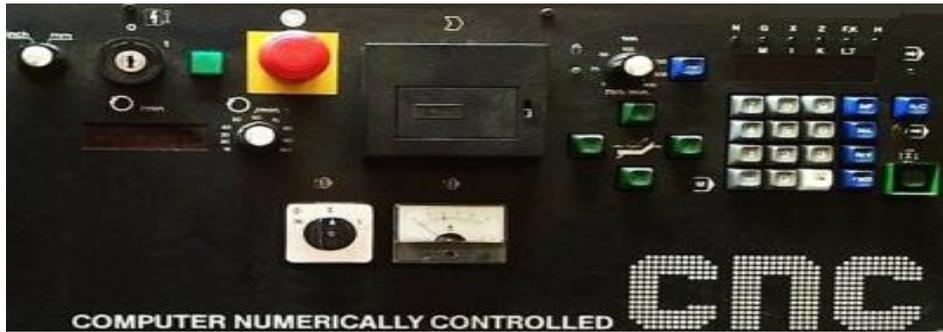
Figure IV.22 :clavée de la partie commande d'une tour EMCO COMPACT 5 CNC
