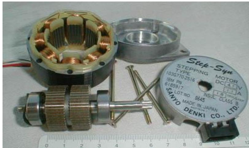
Figure III.7 : exemple de moteur pas a pas.
