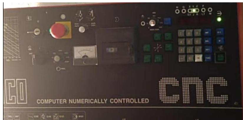
**Figure IV.12 :** clavier de la partie commande du tour EMCO COMPACT 5 CNC
