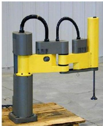
**FigureI.6 :** Exemple de robot d'assemblage.
