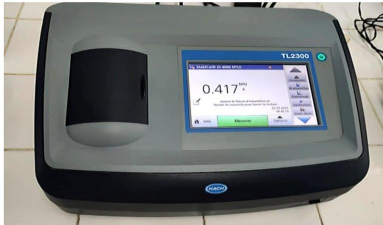
Figure 14 : Turbidimètre [28]
