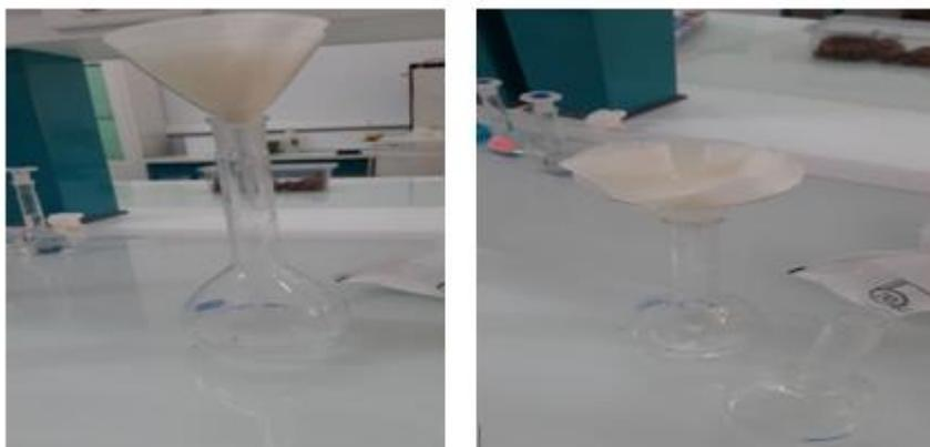
*Figure III.12: filtration et récupération de la solution principale*
