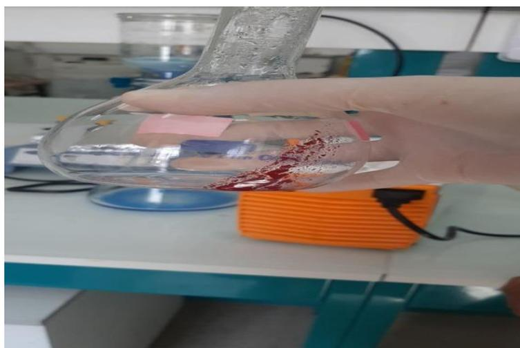
*Figure III.14: Obtention de précipité d'oxyde cuivreux*
