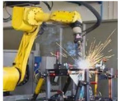
Figure 2.34 : Robot soudeurs à l'arc.
