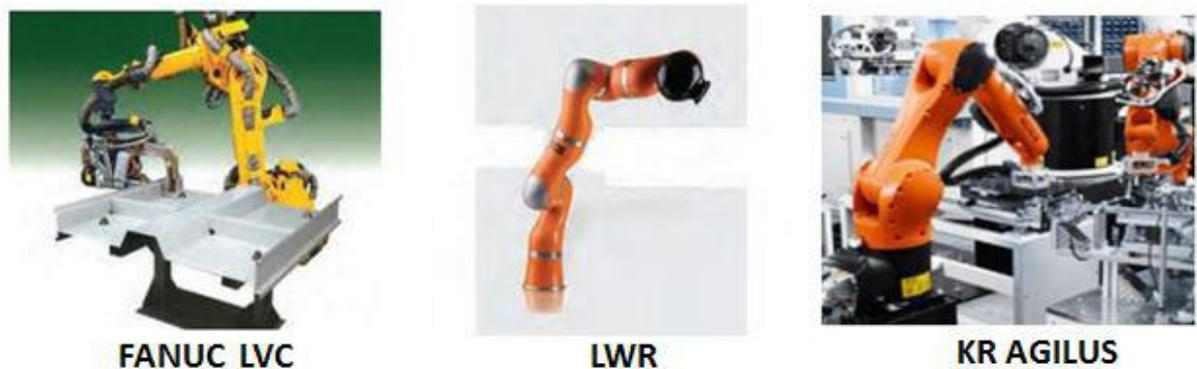
Figure 2.8 : Les robots industriels LVC, LWR et KR AGILUS
