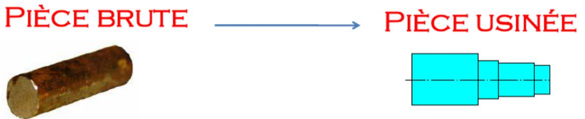
Figure4.9 : transfert de pièces par tournage.
