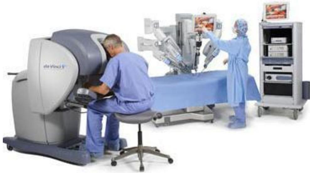
Figure 1.23 : Robot chirurgical Da Vinci
