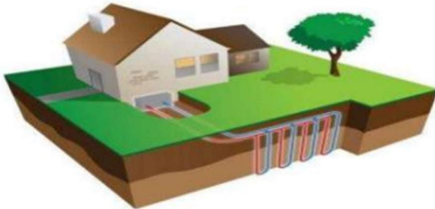
Figure I-11 : Echangeur Serpentins [13].
