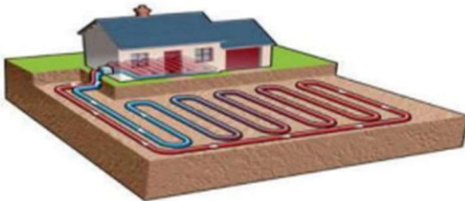
Figure I-10 : Échangeur horizontal [13].
